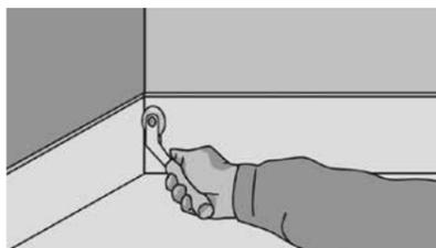
**Рис. 64.** Крепко прижмите материал к углу угловым роликом.
