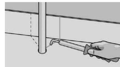
**Рис. 70.** При укладке напольного покрытия вокруг труб рядом со стенами, надрежьте покрытие и прижмите его к трубе, чтобы сформировать «воротник». Если расстояние между трубой и стеной маленькое, сделайте надрез так, чтобы потом осталась возможность его сварить. Т.е. качество сварки и последующая функциональность имеют приоритет над эстетическим внешним видом. Если нужно сделать обшивку, вам необходимо:
