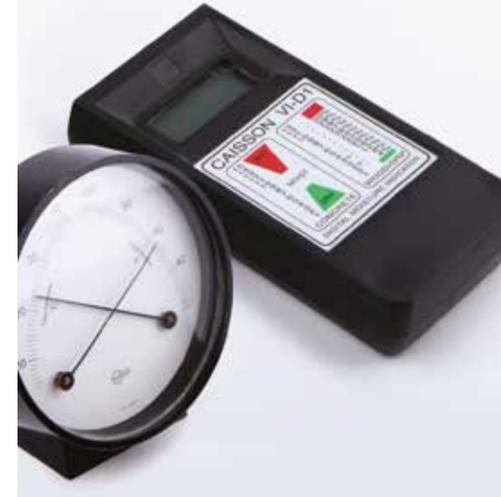
**Шведский RH-метод:** относительная влажность измеряется в отверстии, просверленном в бетонной плите на определенную глубину. Этот метод используется примерно с 1980 года и при соблюдении всех необходимых условий является достаточно точным. Согласно шведскому RH-методу максимальная влажность основания для укладки линолеума и других коммерческих покрытий 85% RH.
