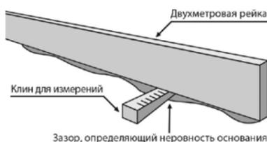
*Рис. 1.* Измерение неровности основания
