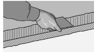
Рис. 58. Используя прямой угол и карандаш, нанесите отметки на высоте 10 см по всей стене, где будет укладываться покрытие. Нанесите клей с помощью мелкозубчатого шпателя по всему периметру от низа стены до отмеченной линии там, где будет укладываться напольное покрытие. Нанесите некоторое количество клея на пол, как показано на рисунке.
