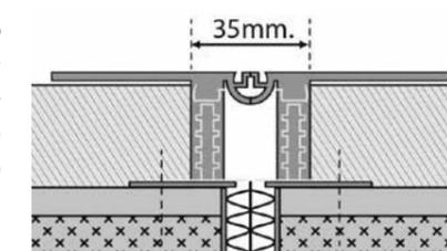
Рис. 22. MIGUA – заделка деформационных осадочных швов Fr30
