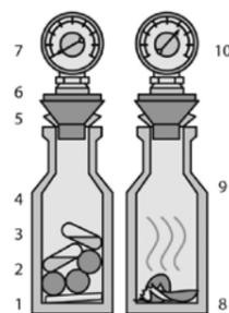
Рис. 10. Прибор СМ (измерение при помощи карбидно-кальциевого метода)
