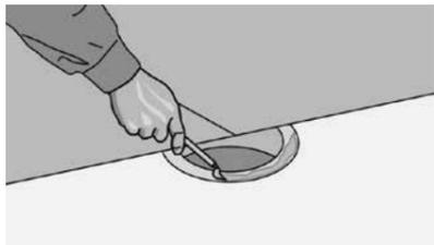
**Рис. 61.** Отогните и ослабьте листы. Нанесите клей на основание мелкозубчатым шпателем. Используйте мягкую кисточку вокруг водосточков и в труднодоступных местах. Вокруг внутренних водосточков используйте контактный клей. Следуйте инструкциям производителя клея.
