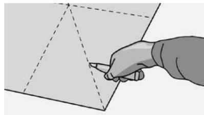
**Рис. 66.** Когда закрепляете внешний угол, покрытие нужно отогнуть от стены и сделать прорез в 5 мм от пола. Затем если необходимо, выполните подрезку линолеума на стене под углом 45°.
