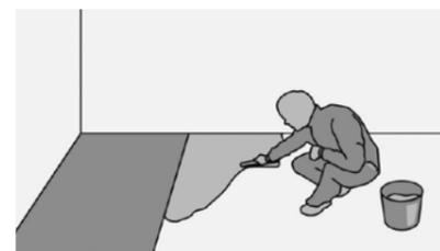
Рис. 23. Нанесение клея
