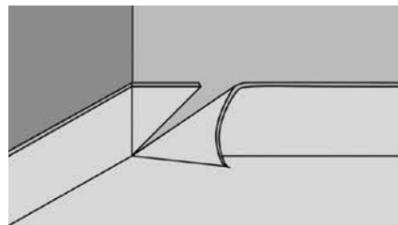
**Рис. 65.** Угловой шов должен находиться на одной из стен под углом 45°, так, чтобы он был менее заметен.
