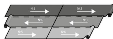
Рис. 25. Укладка покрытия с абстрактным рисунком и гомогенного покрытия
