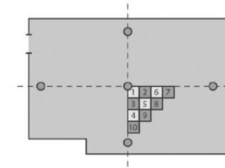
Начинать укладку ковровых плиток следует от центральной осевой линии и вести от себя (находясь на ранее уложенных плитках) в одну из сторон в соответствии с направлением рисунка, указанного стрелками на тыльной стороне плиток. Края ковровых плиток должны плотно прилегать друг к другу, между ними не должно быть зазоров.
