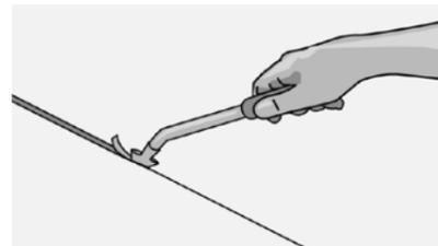
Рис. 27. Сделайте канавку резакром.
