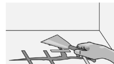
*Рис. 6.* Убрать выступающую на поверхность смолу
