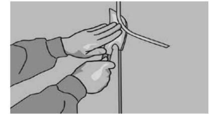
Рис. 95. Для лучшего результата обрежьте излишки сварочного шнура в два этапа. В первый раз вы обрежете основные излишки. Во второй раз - чистовая подрезка шва (см. рис.95).
