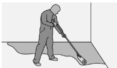
Рис. 20. Грунтование стяжки
