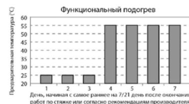
Рис. 15. Функциональный подогрев
