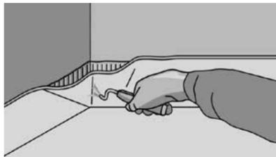
**Рис. 63.** Когда делаете укладку в углу, сделайте надрез на излишке покрытия, начиная примерно в 5 мм от угла пола. Перед тем, как начать сгибать напольное покрытие, его необходимо нагреть
