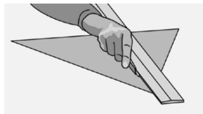
**Рис. 67.** Для закрытия оставшегося участка угла стены требуется изготовить треугольный элемент покрытия. С обратной стороны данного элемента, на месте сгиба, выполните канавку с применением резака для подрезания с обратной стороны.
