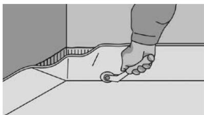
**Рис. 62.** Прогрейте покрытие и, используя угловой ролик, прижмите покрытие в соединении между полом и стеной. В помещениях, где достаточно одного куска напольного покрытия, клей может быть нанесен на всю поверхность основания, куда будет укладываться покрытие. Хотя это требует опыта, этот метод является самым быстрым.
