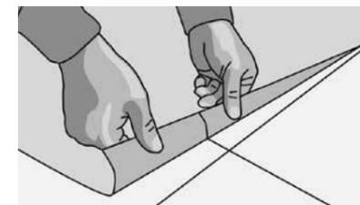
Рис. 60. Когда ширина помещения превышает ширину рулона (необходимо использовать более одного куска покрытия, чтобы покрыть помещение), проведите линию на основании параллельно периметру стены на расстоянии 12 см от края покрытия. Отметьте центр комнаты на этой линии. На обратной стороне каждого куска покрытия отметьте их центр. Крестообразные отметки на листах и основании должны совпадать друг с другом.
