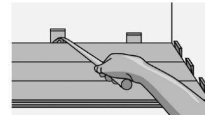
Рис. 99. После укладки первых трех рядов нужно выставить компенсационный зазор по длинной стороне. Для этого нужно отодвинуть уложенный паркет от стены и вложить расширительные клинья
