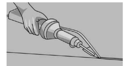
**Рис. 75.** Сделайте горячую сварку с помощью сварочной насадки. Сварку можно производить через 24 часа после приклеивания
