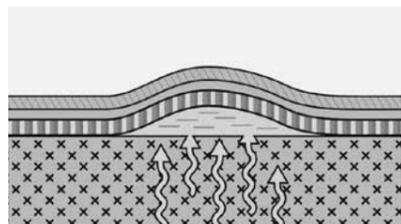
Рис. 9. Следствие избыточной влажности основания
